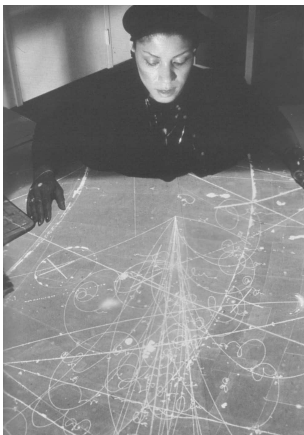
Rys. 9. Zakrzywiające się linie na tym zdjęciu z komory pęcherzykowej pokazują tory – a przez to rodzaje – różnych subatomowych cząstek powstających w akceleratorze. Dokładne zbadanie tych śladów (tutaj robi to Renee Jones z Fermilabu w ramach doświadczenia z 1984 r.) pokazuje własności niezostawiających śladów obiektów, które – rozpadając się – są źródłami takich strumieni cząstek. Jak większość współczesnych badaczy, autorzy niniejszego artykułu zamiast komór pęcherzykowych wykorzystują detektory elektroniczne, unikając dzięki temu tego pracochłonnego etapu polowania na szczególnie przypadki cząstek egzotycznych, czyli takich, które są utworzone (w całości lub części) z obiektów zazwyczaj odpowiedzialnych tylko za oddziaływanie wiążące materię (fot. David Parker, Science Source/Photo Researchers, Inc.).
